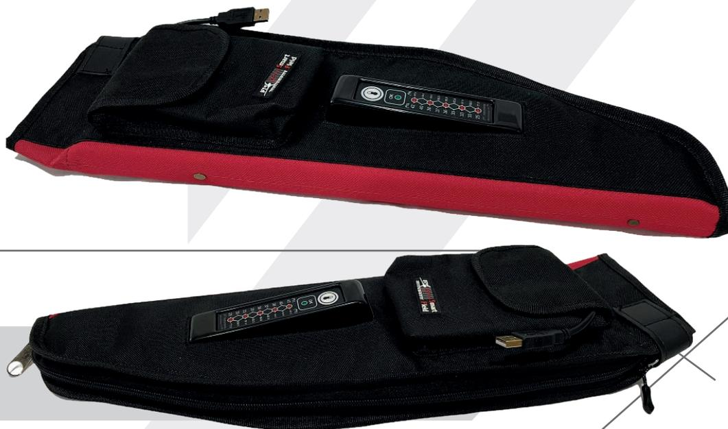
*Instrumento para mantener las vaginas artificiales a la temperatura correcta para evitando el Shock térmico.*
